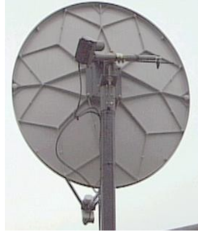
Klasik aktüatörlü hareketli antenlerin değişik polar mount mekanizmaları bulunuyor
