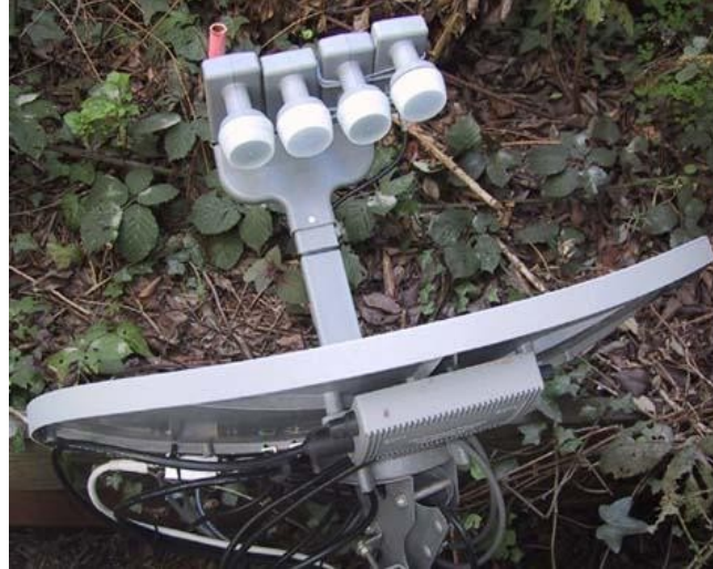
4 slota yayılmış uydularda yayınları bulunan bir Amerikan paralı buketi için yapılmış 4 LNB'li özel offset çanak
