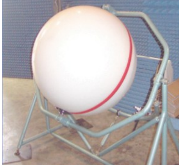
Lüneburg lensi prensibine göre yapılmış küresel uydu anteni
