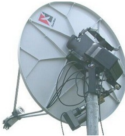
Klasik aktüatörlü hareketli antenlerin değişik polar mount mekanizmaları bulunuyor
