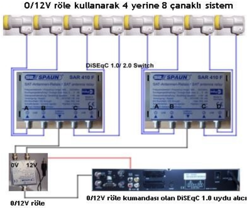
Şekil 4-37: 0/12V röle kullanarak 4 yerine 8 çanaklı sistem
