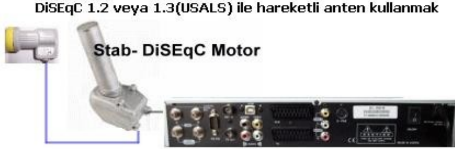
Şekil 4-39: DiSEqC 1.2 veya 1.3 ile hareketli anten sistemi
