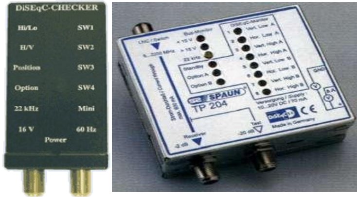
Şekil 4-30,31: Emitor ve Spaun'un DiSEqC -Sinyal test(check) cihazları
