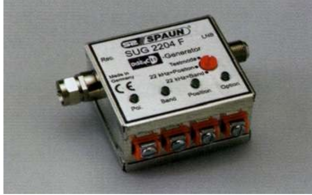
0/12 Volt besleme ile çalışan bir DiSEqC sinyal üreticisi
