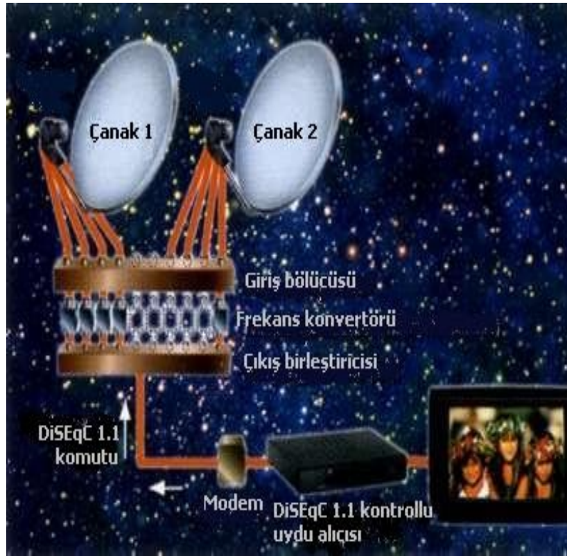
Şekil 4-27: Kullanıcı kontrollu apartman uydu yayını dağıtım sistemi.
